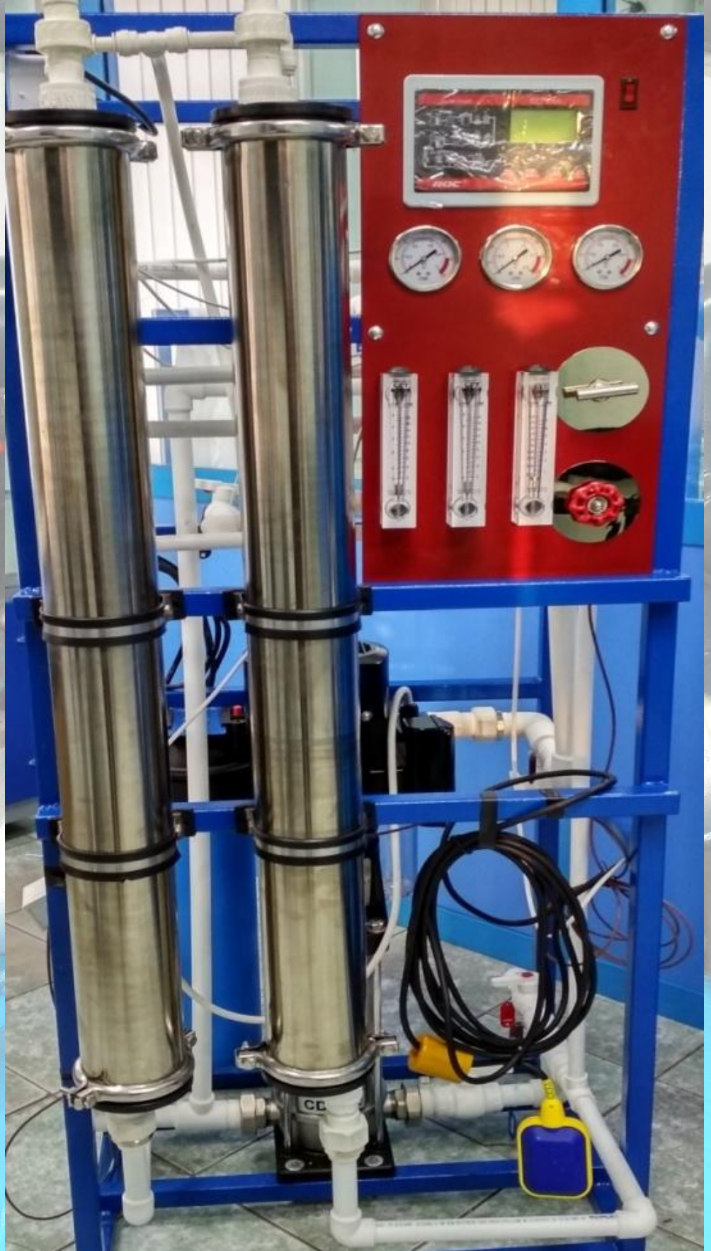
Модуль тонкой очистки установки АФС-М
